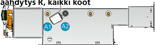
Kuva 22. Vesiliitântä oikealla puolella (R).
