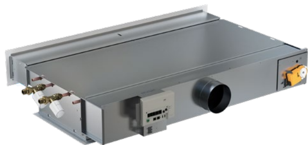
Kuva 12. WISE Paragon, jossa vesiliitäntä vasemmalla puolella. Täydellinen tuote, jossa on tehtaalla asennettu WISE CU -ohjausyksikkö, toimilaitteet sekä venttiilit ja venttiilitoimilaitteet jäähdytys- ja lämmitysvettä varten.
