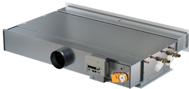
Kuva 11. WISE Paragon, jossa on tehtaalla asennettu WISE CU -ohjausyksikkö, toimilaitteet sekä venttiilit ja venttiilitoimilaitteet jäähdytys- ja lämmitysvettä varten.
